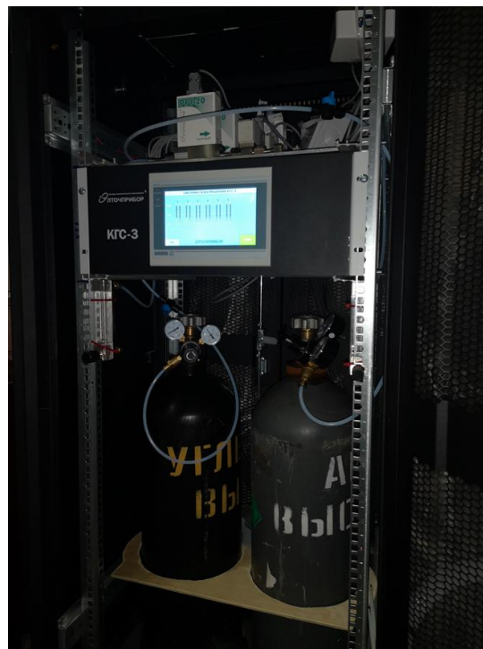
Рис.6 Система дистанционного управления газом.
