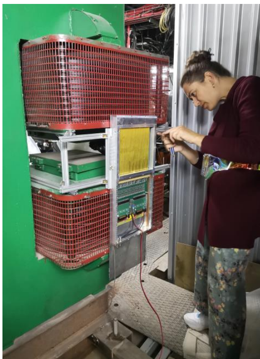
Рис.5 Установка дрейфовой камеры.
