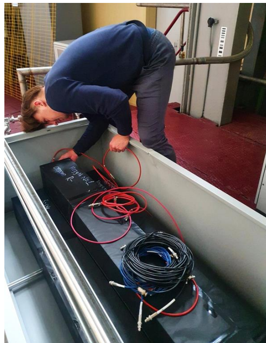
Рис,9 Установка нейтронных модулей.
