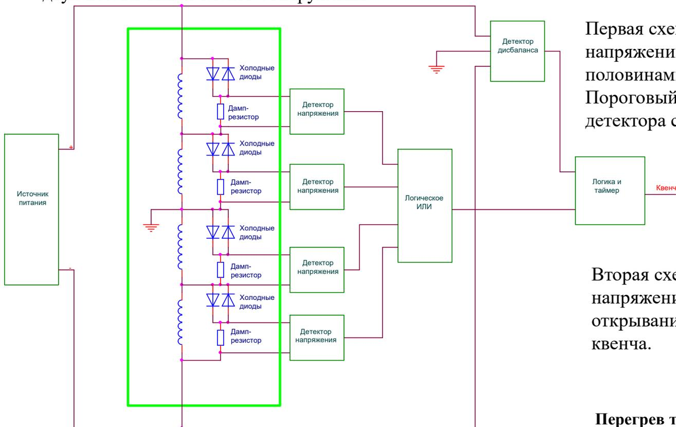
Первая схема обнаруживает дисбаланс напряжений между верхней и нижней половинами вигглера в случае срыва. Пороговый дисбаланс для срабатывания детектора составляет около 5В.
