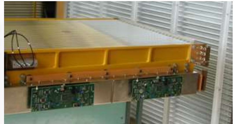
Для мю-томо (бестриггерная мода) – платы МТ-48 с ВЦП и встроенными усилителями (48 каналов)
