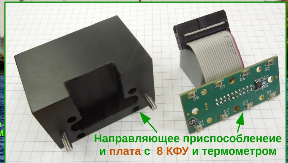
Направляющее приспособление и плата с 8 КФУ и термометром
