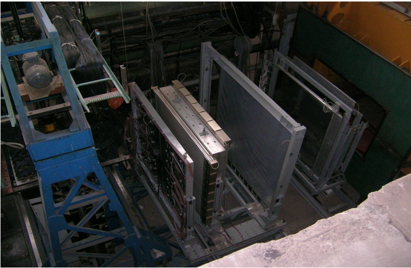
Straw и ДТ камеры, матричный годоскоп, электромагнитный калориметр ГАМС-2000
