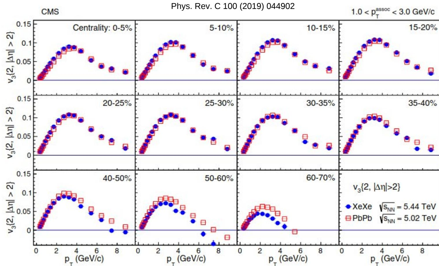
Результаты для  $v_3$ , полученные на эксперименте CMS методом двухчастичных корреляций.
