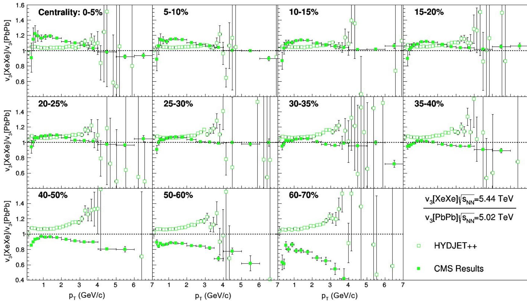
Результаты для отношений  $v_3$  получены в генераторе HYDJET++ относительно истинной плоскости реакции (статистика ок. 1 млн. событий для каждой центральности) и в эксперименте CMS методом двухчастичных корреляций
