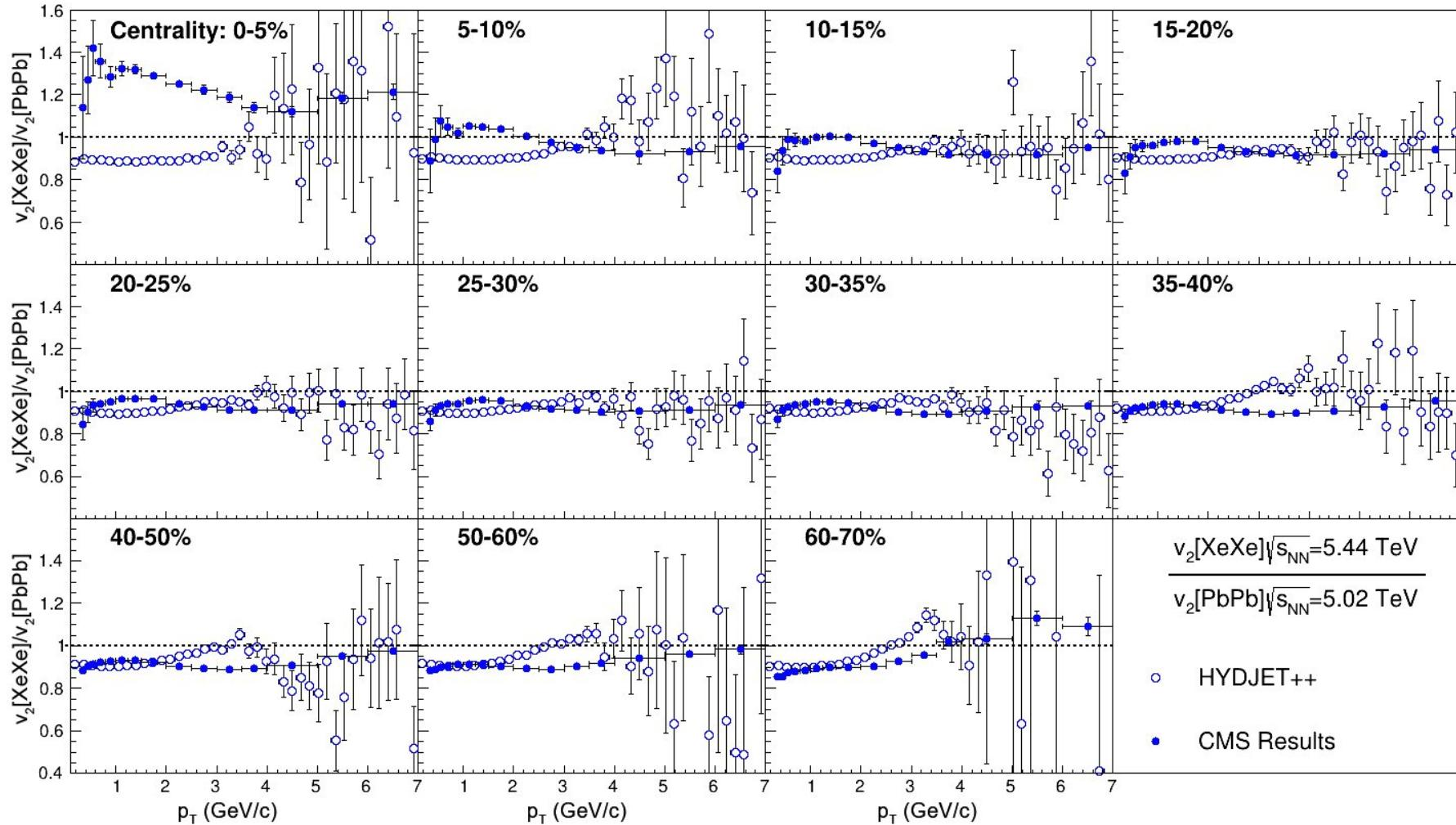
Результаты для отношений  $v_2$  получены в генераторе HYDJET++ относительно истинной плоскости реакции (статистика ок. 1 млн. событий для каждой центральности) и в эксперименте CMS методом двухчастичных корреляций
