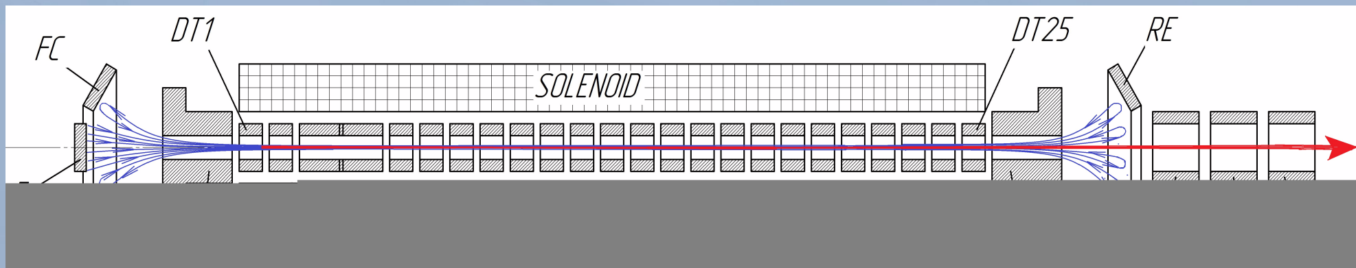
Рис. 3 Устройство электронной и ионной оптики в ионных источниках типа КРИОН
