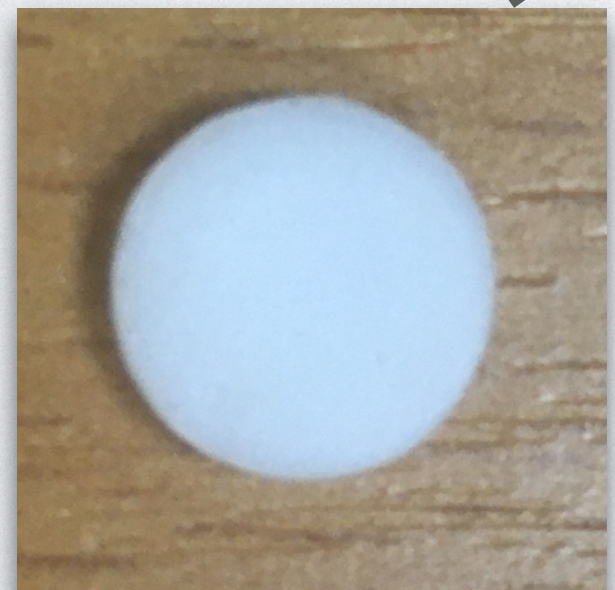
Attenuator-Diffuser PTFE/0.5 mm
