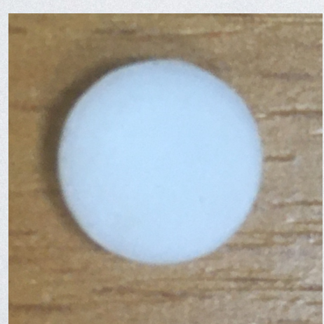
Attenuator-Diffuser PTFE/0.5 mm
