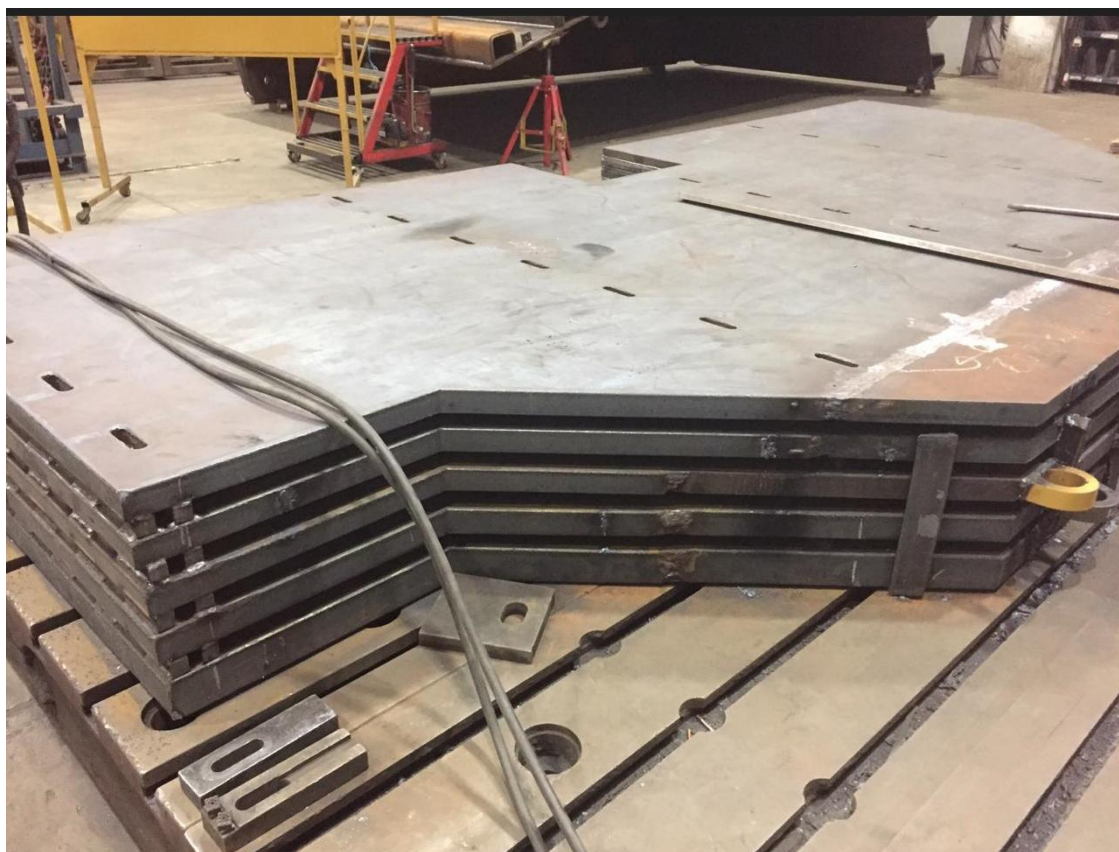
Рис. 7. Сборка створок дверей на мастер-плите.
