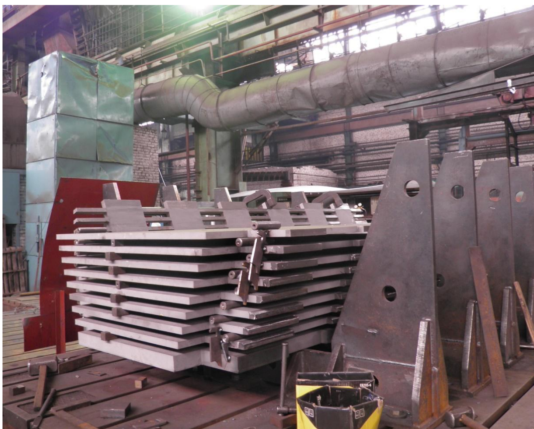
Рис. 6. Примерный вид спецстанеля для сборки модулей
