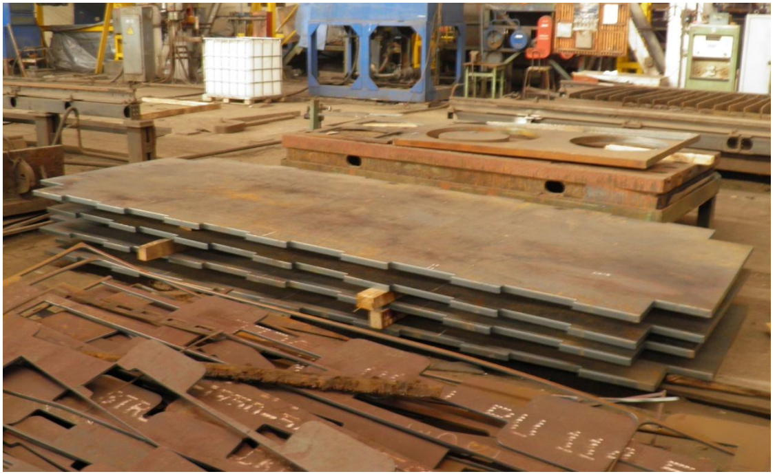
Рис.4 а) Предполагаемый раскрой листов для модулей барреля.
