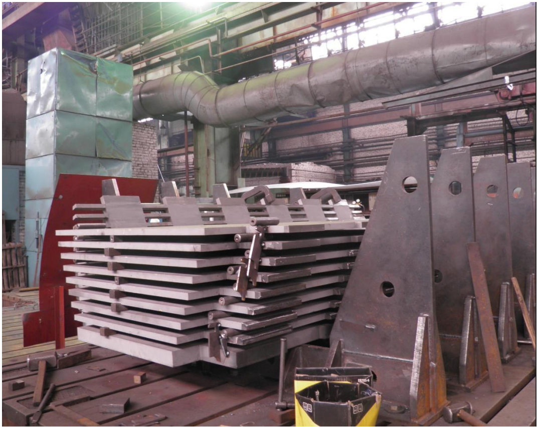
Рис. 4 Примерный вид спецстопеля для сборки модулей.
