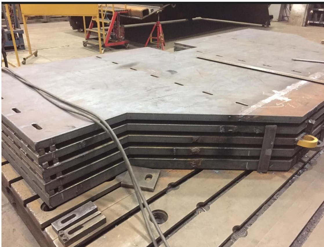
Рис. 6 Сборка створок дверей на мастер-плите.
