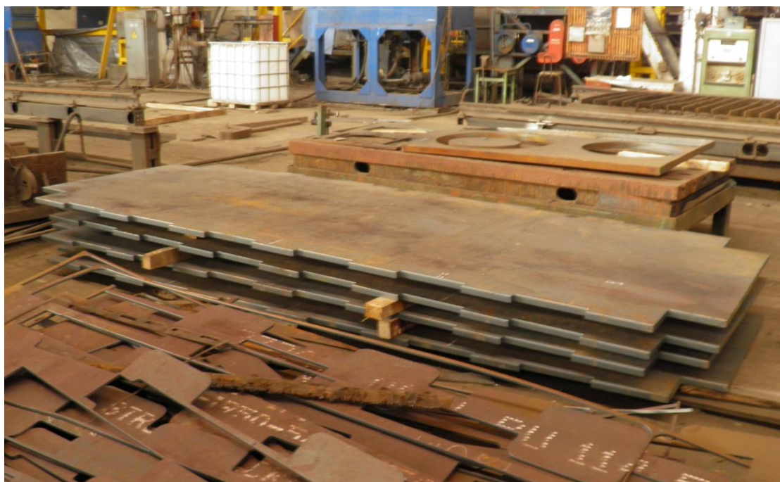
Рис.1 Предполагаемый раскрой листов для модулей барреля.
