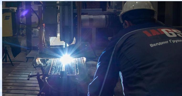
Производство оснащено сварочным комплексом, предназначенным для выполнения автоматической наплавки поверхностей изделий, что позволило достичь отличных показателей качества сварных соединений и добиться высоких показателей производительности.
