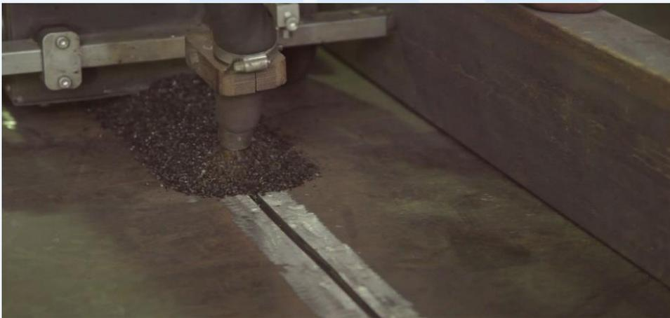
Сварочный трактор можно быстро переналадить для сварки различных изделий, программировать и управлять всеми сварочными параметрами.
