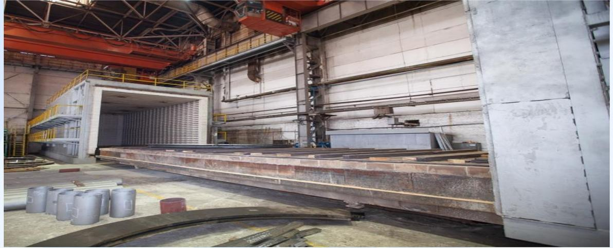
В 2017 году в цехе №17 была установлена и введена в эксплуатацию колпаковая электropечь ПКК 86.60/8 для отпуски сварных конструкций с рабочими размерами печи  $\varnothing 8400$  мм x 6000мм
