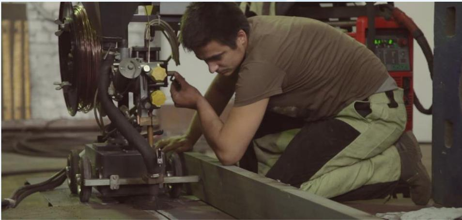
На предприятии активно используется технология автоматической сварки под слоем флюса стыковых соединений крупногабаритных листов длиной до 6 метров и толщиной до 40мм с применением тракторов для автоматической сварки производства «ESAB», позволяющих получать качественные и надежные сварные соединения.
