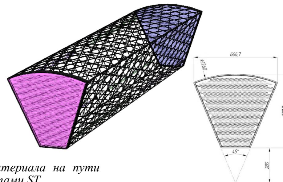
*Слабое место данной конструкции: наличие материала на пути частиц, т.е. между VD и ST, а также между октантами ST.*
