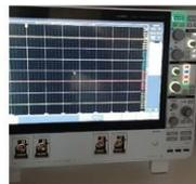
Быстродействующий цифровой осциллограф Tektronix MSD064-BW4 с полосой 4 ГГц и частотой выборок до 25 ГГц
