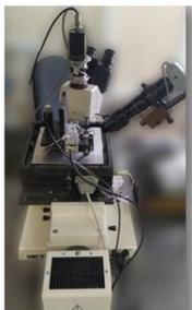
Сканирующий ближнеполевой оптический микроскоп
