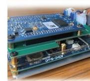
Квантово-оптические генераторы случайных чисел на одиночных фотонах, используемые в криптографических системах для обеспечения информационной безопасности
