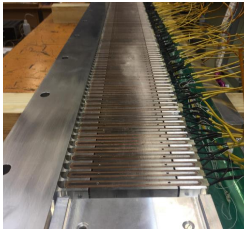
Нижняя половина полюса СП ондулятора с периодом 15.6 мм
