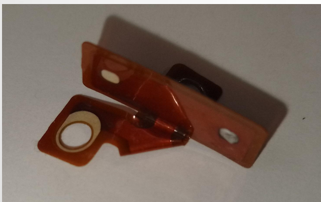
Рис. 8 Конденсатор, подготовленный к монтажу
