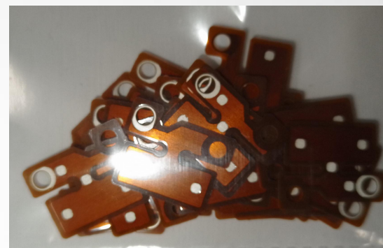
Рис. 7 Межсекционные конденсаторы. Гибкая печатная плата на каптоне.
