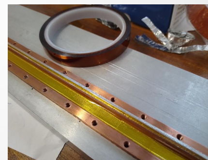
Рис. 9 Юстировка секций. Выставление высоты установки секций слоями каптона
