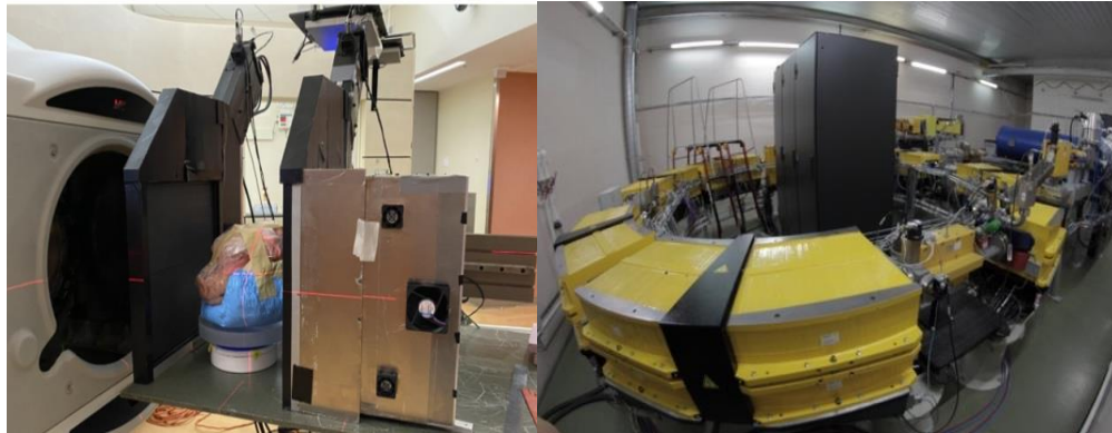
Внешний вид эксперимента по облучению подвижной мишени динамического фантома (слева) и внешний вид протонного синхротрона (справа)
