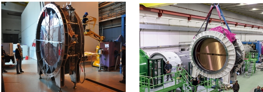
Рис. 2. Стру-камера, собранная из 2 модулей (слева) и ее монтаж в экспериментальную установку NA62 (справа).
