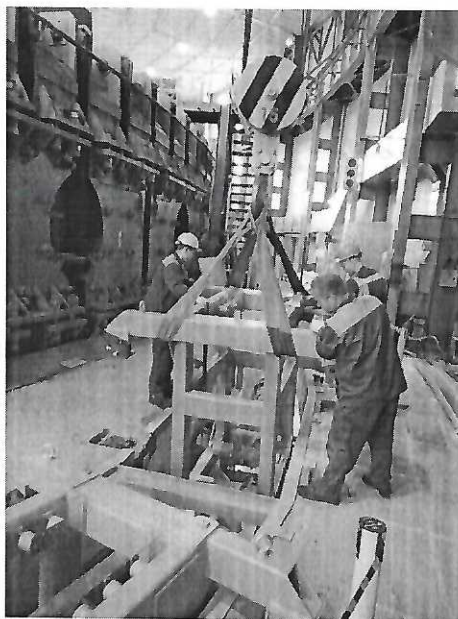
Рис. 1. Элементы канала транспортировки пучка из Бустера в Нуклотрон в процессе сборки.
