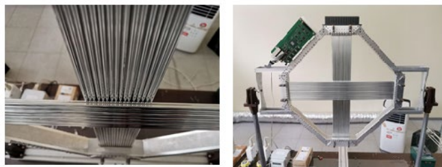
Fig. 24. Assembly of a 64-channel mini prototype of straw tracker module
