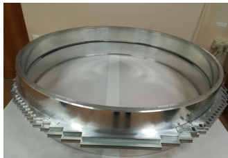
Fig. 25. Straw module frame
