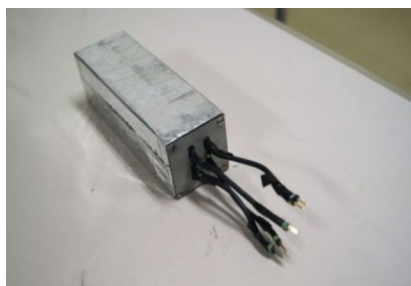
Рис. 38. Кристаллический модуль без платы предусилителя
