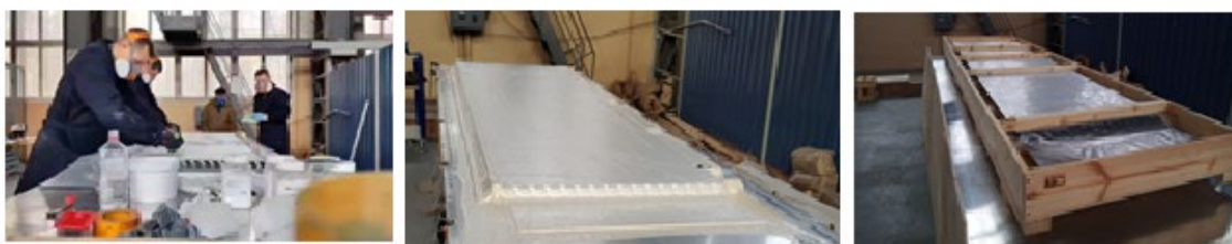
Рис. 54. Процесс склейки; модуль, под вакуумным прессом в 26 тонн; готовый модуль в ящике
