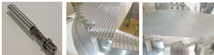
Рис. 22. Сборка станции трекера для Фазы-I
