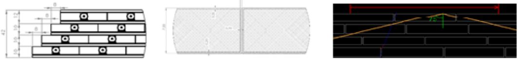
Рис. 45. Паттерн модуля, технологические зазоры. Иллюстрация трека мюонов от -75 до 75 градусов наклона и от -40 до +40 мм от центрального верхнего стрипа
