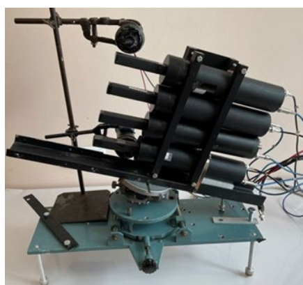
Рис. 36. Прототип COMET калориметра
