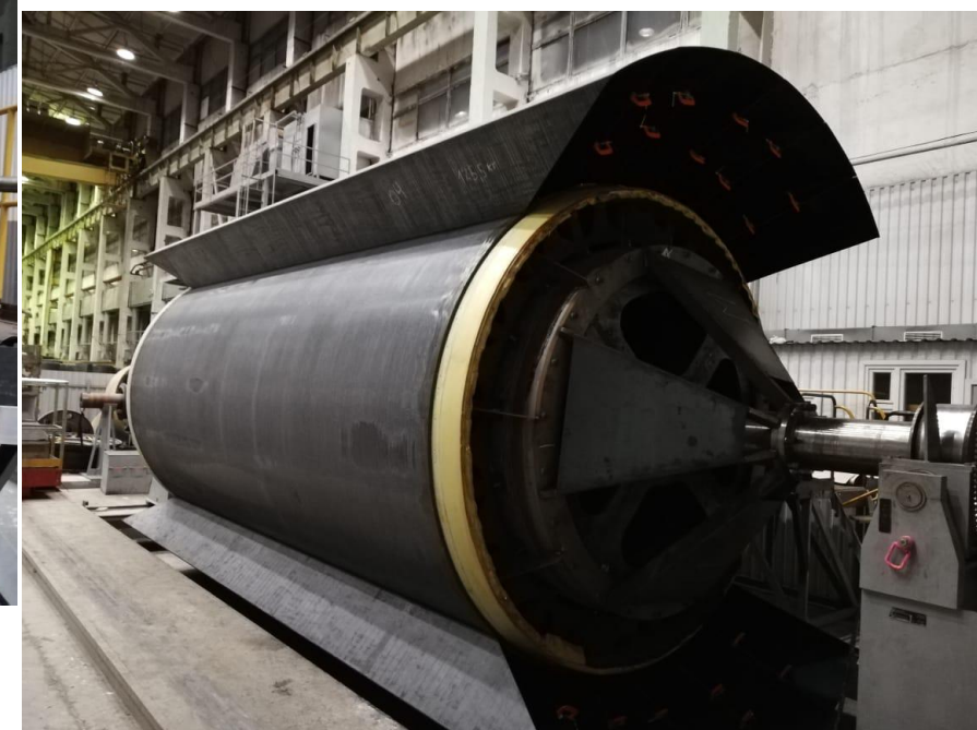
Проверка вхождения корзины в короб_2020_12_23
