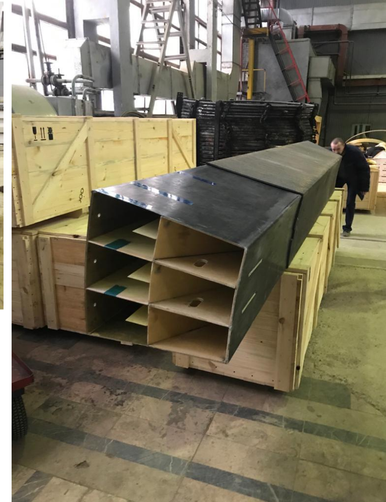
Проверка вхождения корзины в короб_2020_12_23
