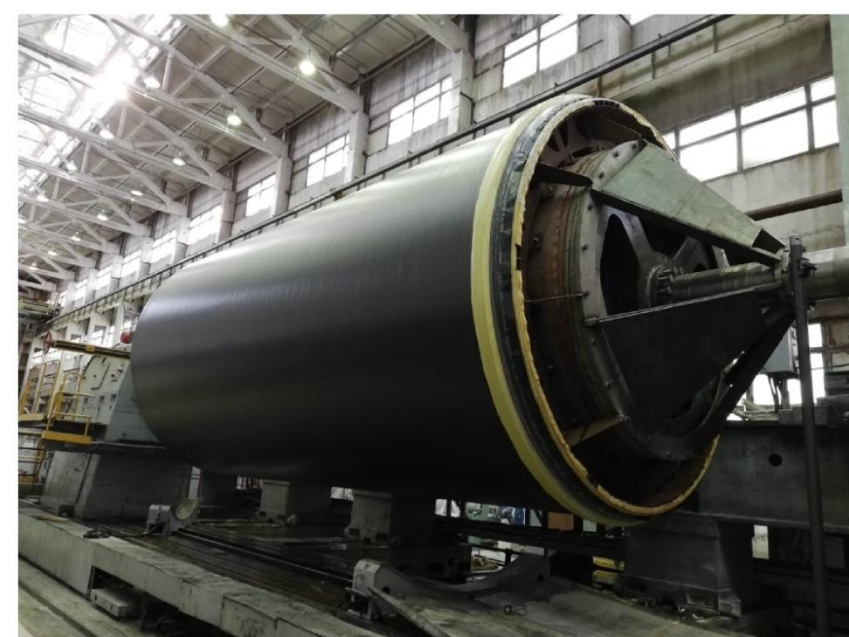
Намотка внутренней обечайки_23_09_2020
