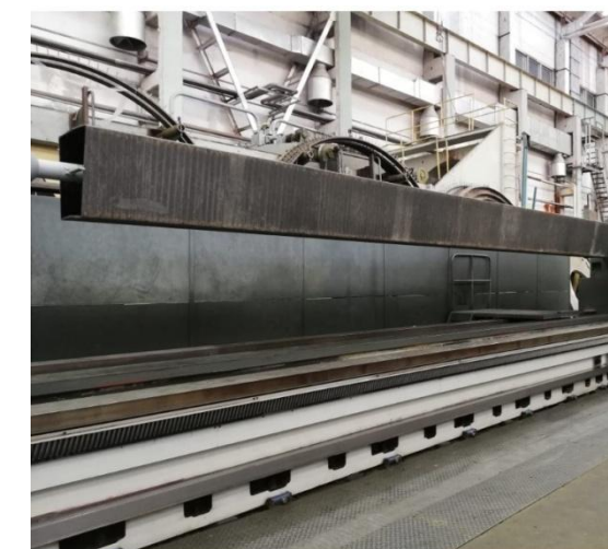
Обработка технологического короба_23.09.2020
