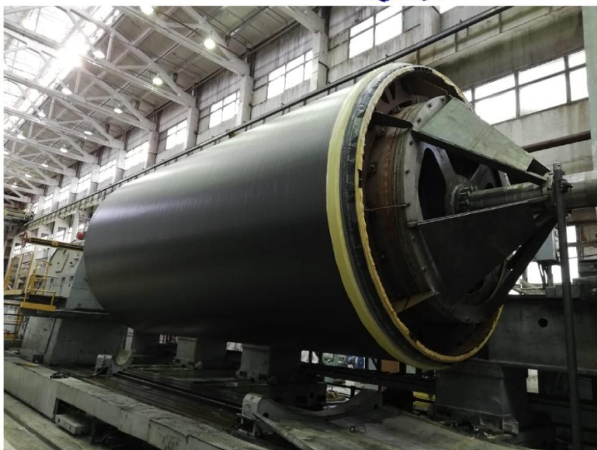
Намотка внутренней обечайки_23_09_2020
