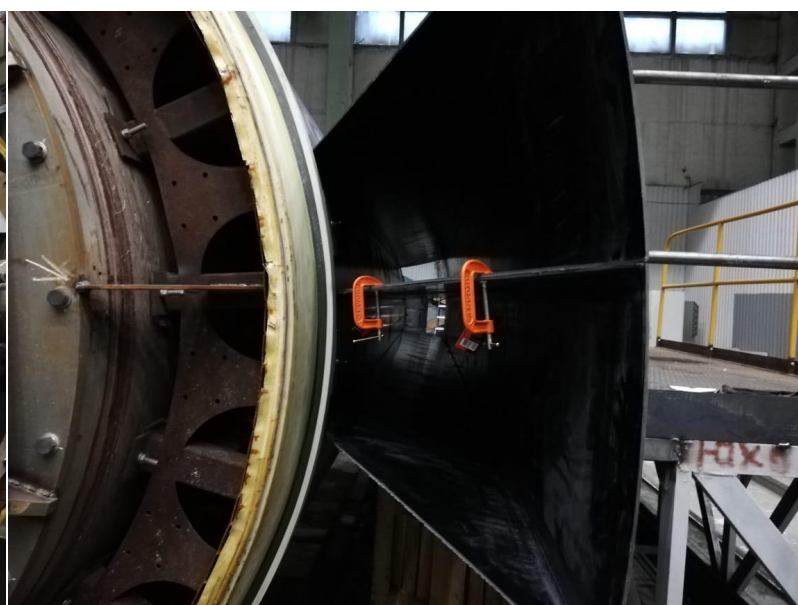
Сухая сборка коробов_3_2020_12_23
