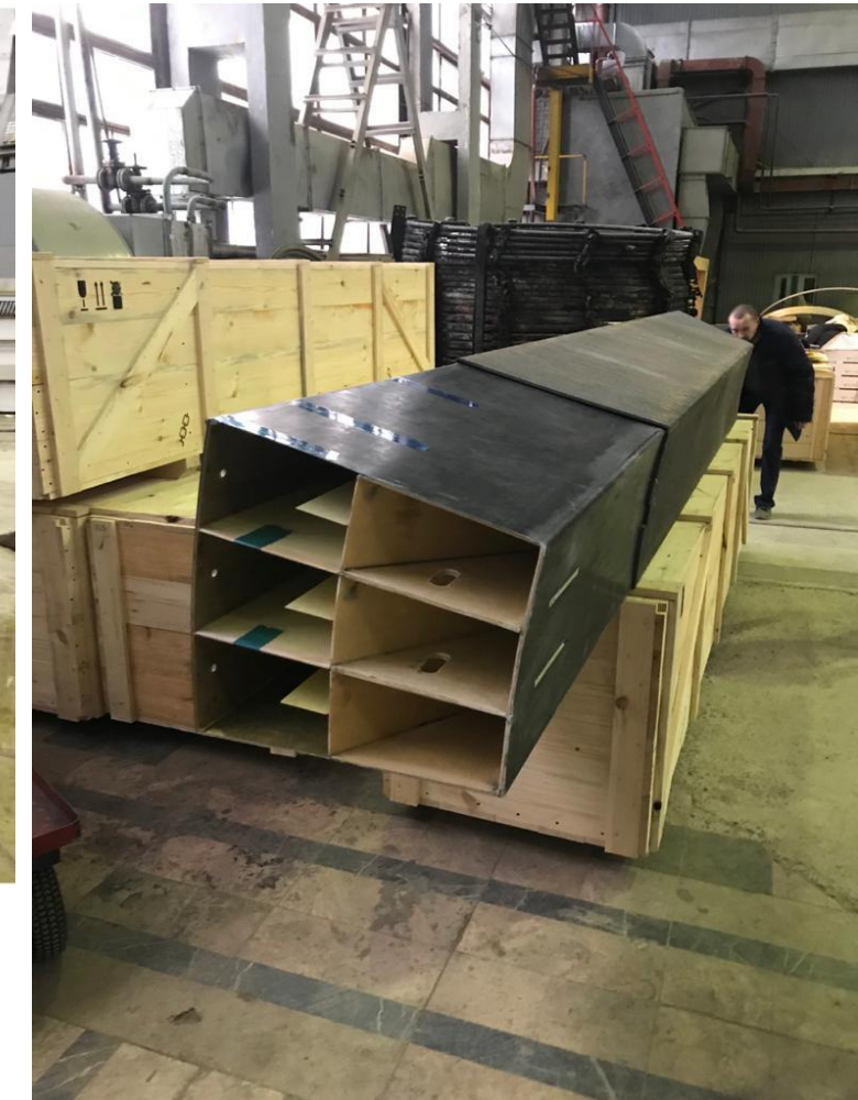
Проверка вхождения корзины в короб_2020_12_23
