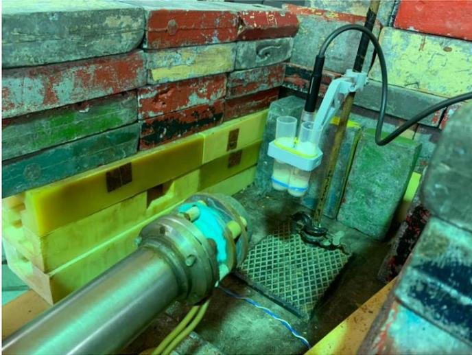
Облучения проводились на третьем канале МТ-25 тормозным излучением, появляющемся в результате попадания ускоренного электрона в мишень (вольфрамовый конвертор).
