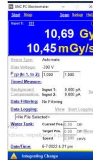
Измерения потока и подсчет поглощённой дозы производились ионизационной камерой «SNC600c» и программным обеспечением от производителя.
