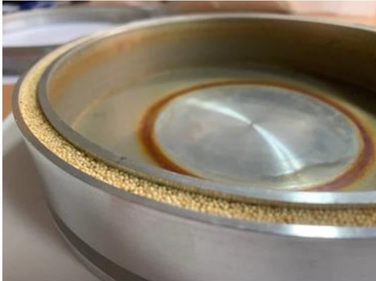
Пробное(оценочное) облучения семян амаранта тормозным излучением с энергией ускоренных электронов 5МэВ. Эксперимент проводился на третьем канале МТ-25.
