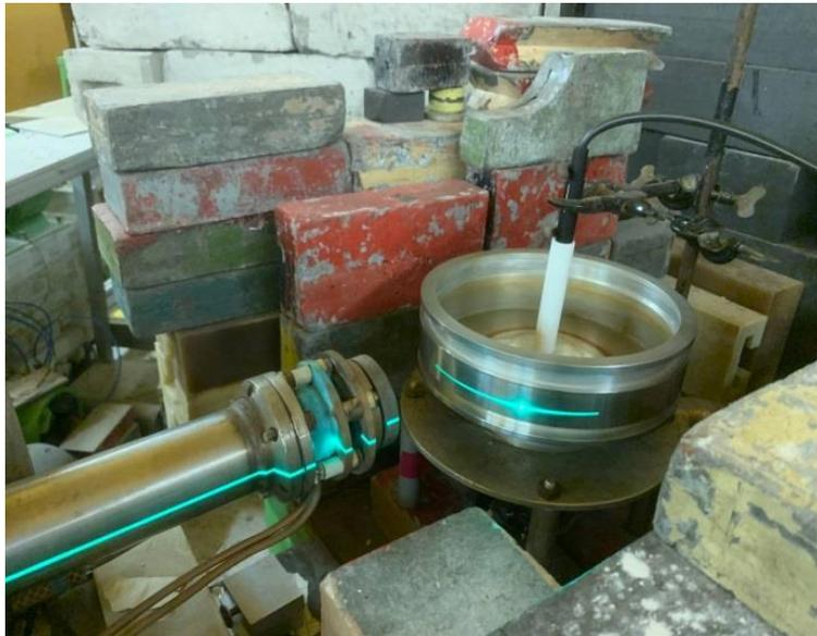
Кювета с образцами установлена на вращающуюся подставку и выставлена по вертикальной и горизонтальной оси пучка.
