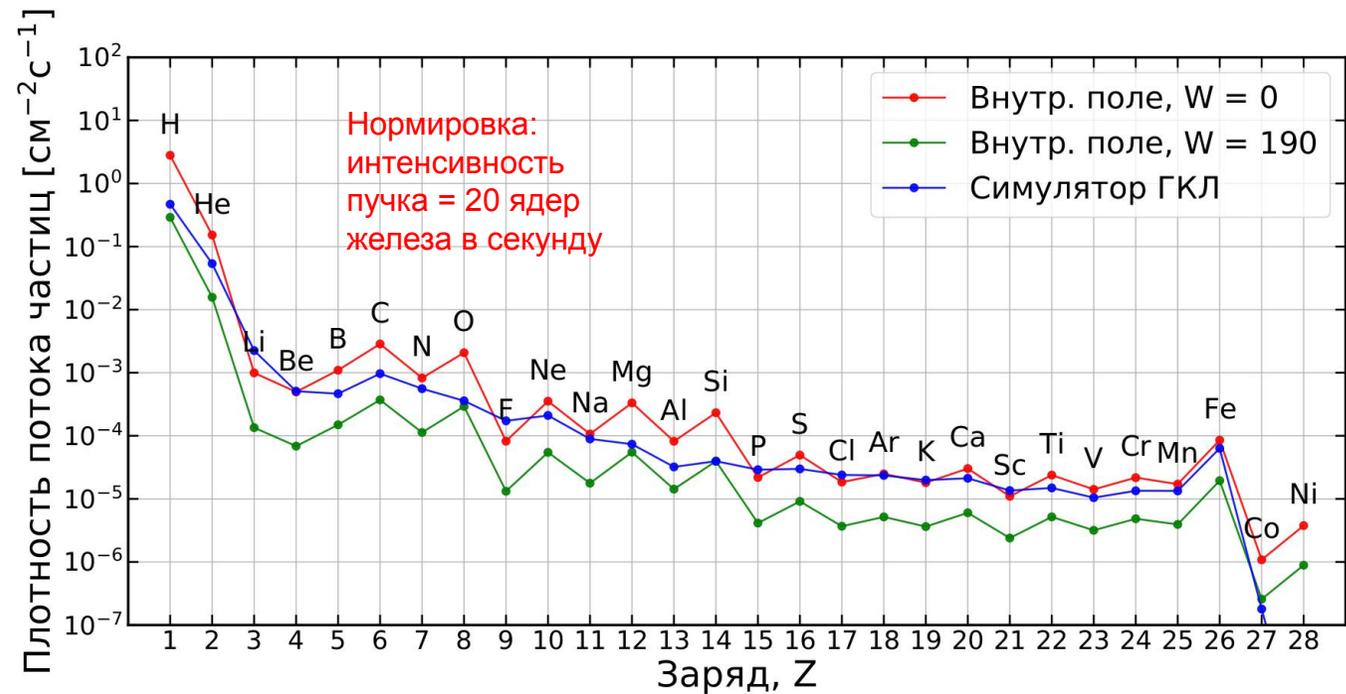
**Сравнение зарядового распределения компонентов внутреннего радиационного поля космического аппарата (расчетных) при мин. ( $W = 0$ ) и макс. ( $W = 190$ ) СА с распределением от симулятора ГКЛ**
