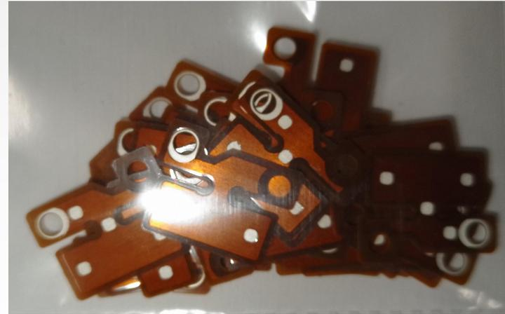
Межсекционные конденсаторы. Гибкая печатная плата на каптоне
