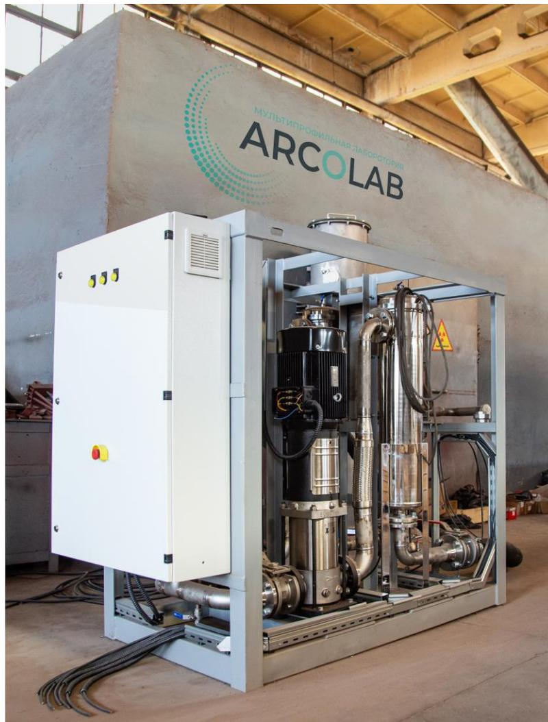
Насосные модули с дублированием и фильтрационными системами
