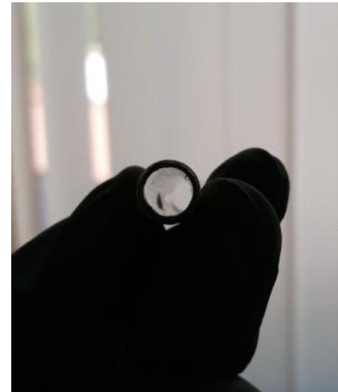
Медная и алюминиевая трубка после 135 часов непрерывной прокачки дистиллированной воды по медно-алюминиевому контуру
