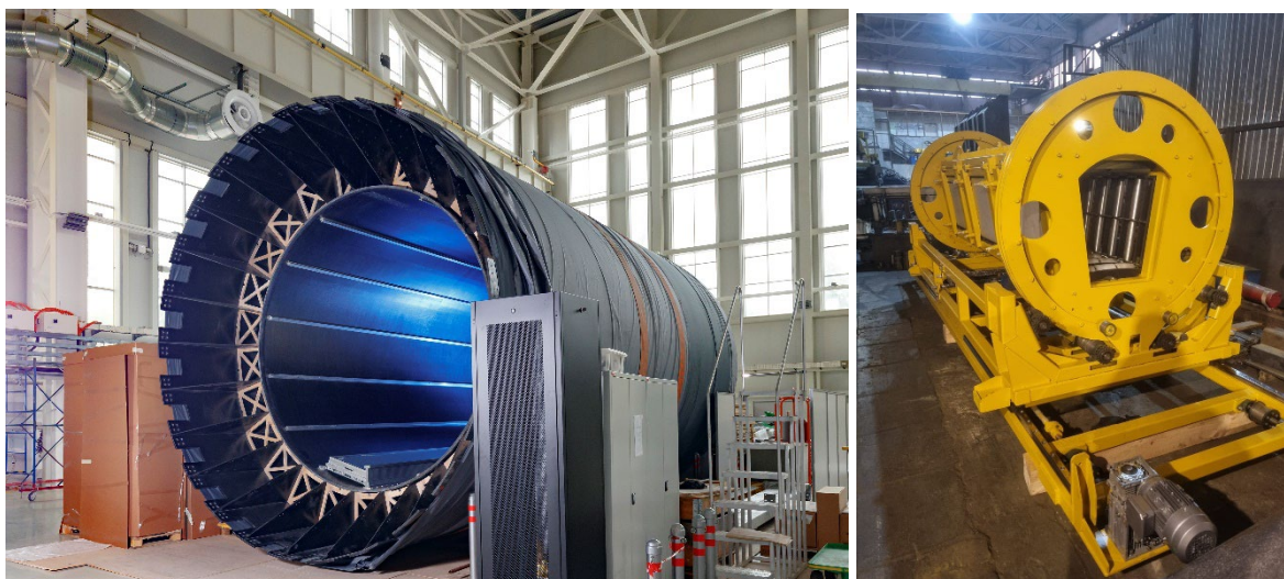
Рис. 3.7.9. Слева: силовой каркас MPD. Справа: устройство для установки полусекторов.
