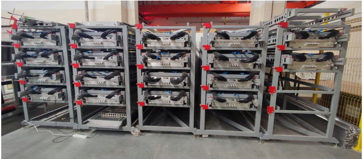
Рис. 3. Собранные и протестированные модули TOF на хранении в стеллажах
