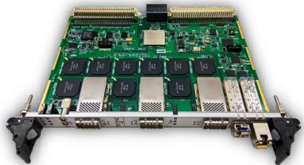
Рис. 5. 72-канальный время-цифровой преобразователь TDC72VXS на базе NPTDC.
