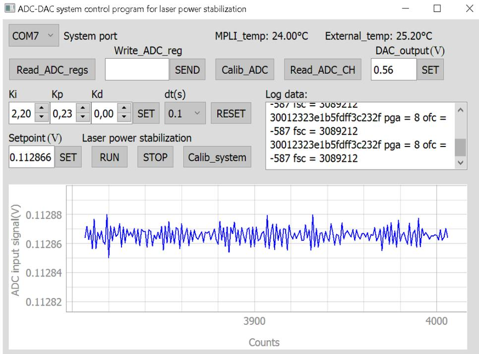
Для управления модулями ССМИ через ПК разработано программное обеспечение нижнего и верхнего уровня с возможностью конфигурации параметров АЦП и ЦАП, цифрового регулятора, запуском процесса стабилизации, мониторингом изменения температуры и т.д.
