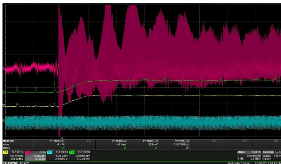
Рис.1. Красный график – суммарный сигнал пучка с 4-го BPM, синий – магнитное поле, желтый и зеленый – ускоряющее напряжение, синий - ВЧ опорный сигнал со старого LLRF.
