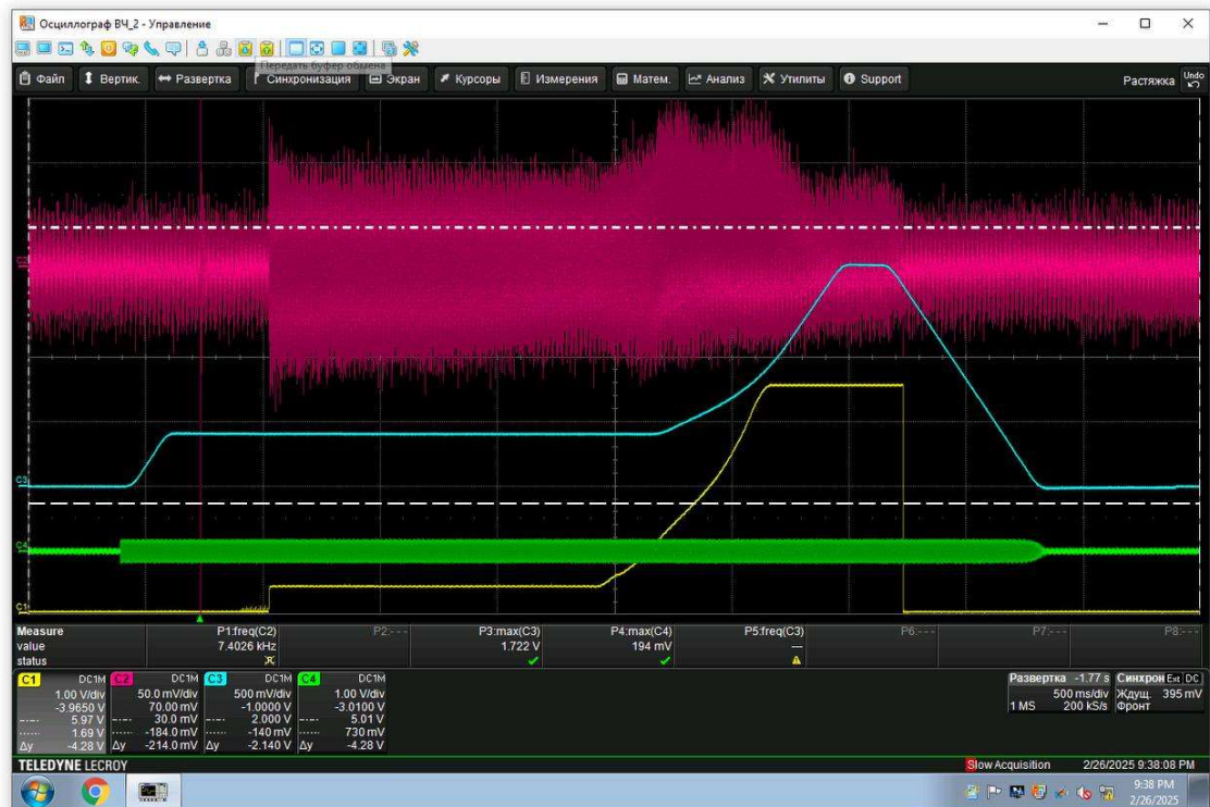
Рис.3б. Красный график – суммарный сигнал пучка с 4-го ВРМ, синий – магнитное поле, желтый – ускоряющее напряжение, зеленый ВЧ опорный сигнал с нового LLRF.
