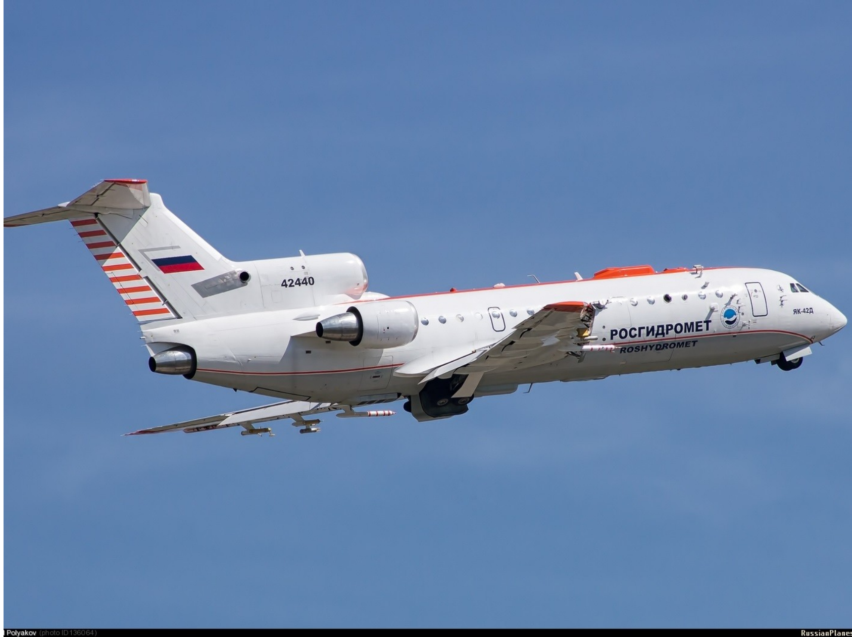
Летающая лаборатория на базе самолета Як-42Д «Росгидромет»
