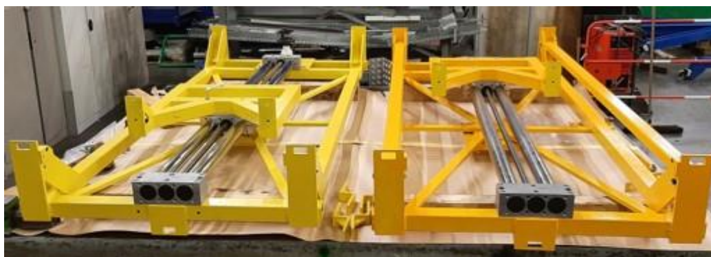
Рисунок 10. Устройства для монтажа камер ME1/1.
