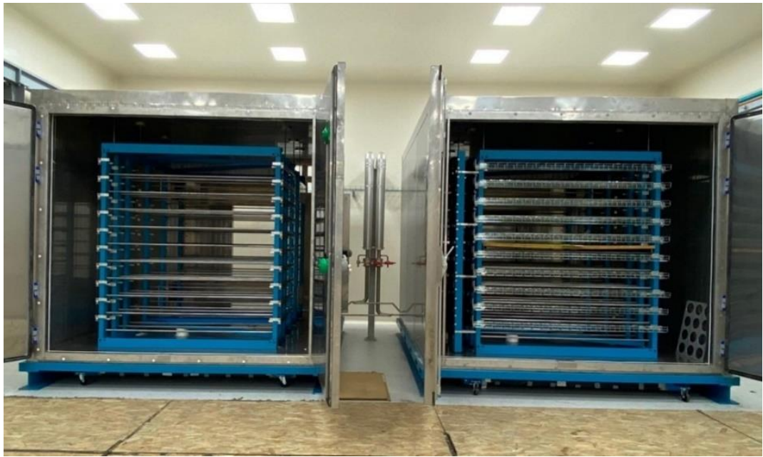
Рисунок 16. Теплоизолированные камеры стенда для проверки кассет HGCal.
