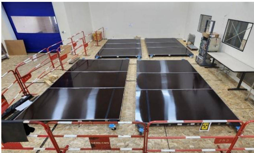
Рисунок 17. Сцинтилляционные триггерные плоскости стенда для проверки кассет HGCal.
