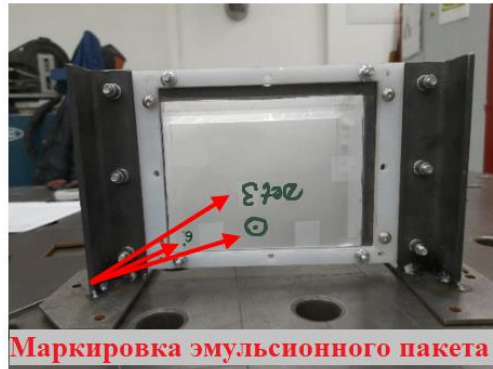
Маркировка эмульсионного пакета Стопка из 6 эмульсий собирается с точностью 1 мм
