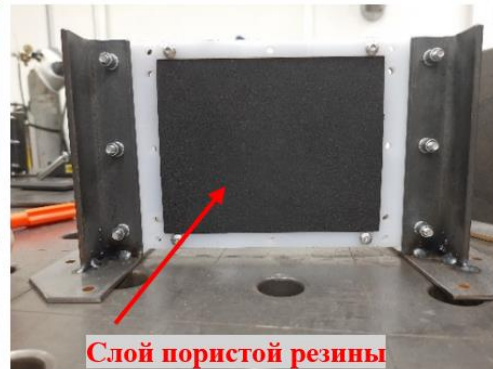
Слой пористой резины Механическая конструкция для защиты от деформаций
