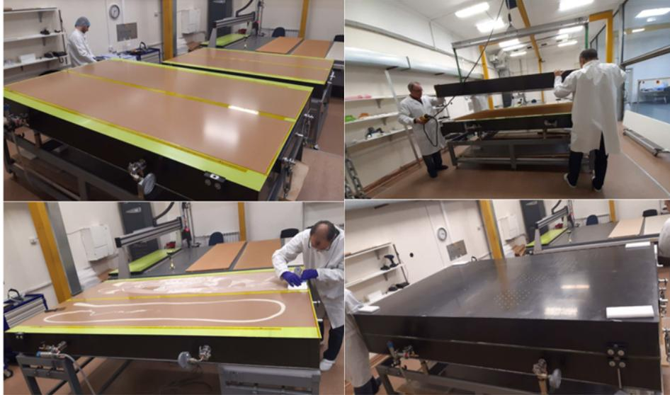
Рис. 10. Технологические этапы процесса производства панелей RPC
