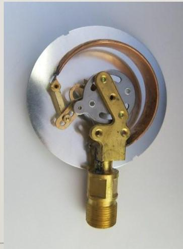
Деформационный вакуумметр с С-образной трубкой Бурдона:
