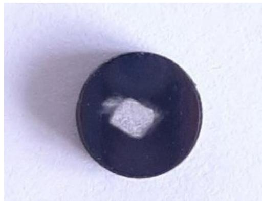
Фотокатод облучался лазерными импульсами с плотностью энергии  $19.4 \text{ mJ/cm}^2$ , число импульсов было  $1.8 \cdot 10^4$
