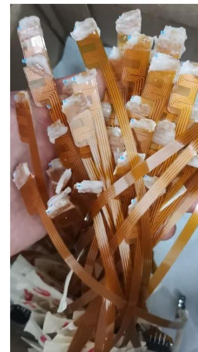
Временная зависимость температуры калибратора      Датчики в парафине перед погружением в калибратор
