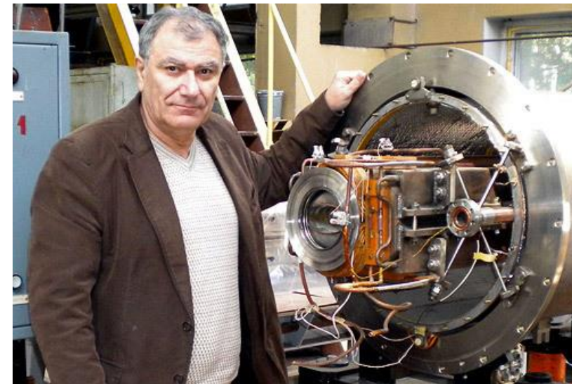
Корпус 203А, 1975 г. Руководитель группы Э. В. Комогоров проверяет сборку магнита РТИ перед монтажом в криостат
