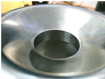
Сетка в положительном электроде системы извлечения
