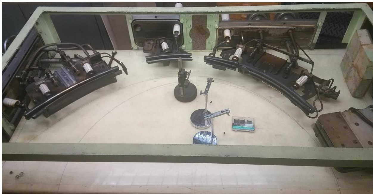
Рис. 12: Система вывода положительных ионов
