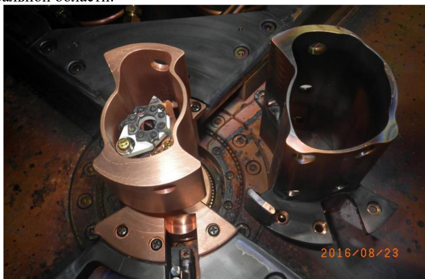
Рис. 31: Фото корпуса инфлектора.
