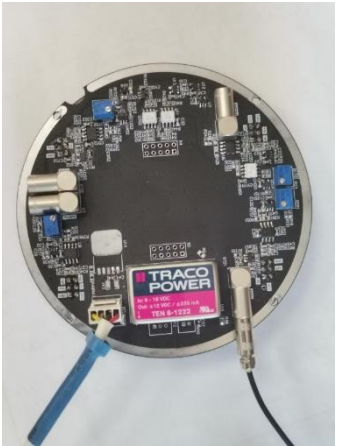
2. Измерительная плата (предусилители – усилители)
