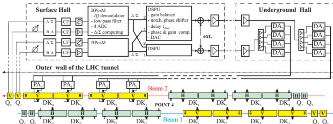
LHC Damper (CERN–JINR digital transverse feedback system)
