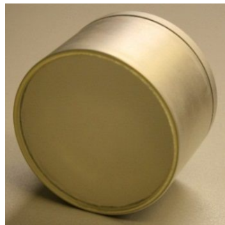
Кристалл стильбена, помещенный в алюминиевый корпус
