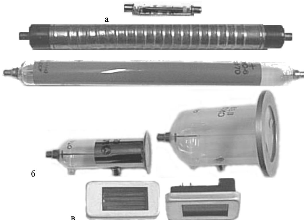
Рис. 3.3: Счетчики Гейгера-Мюллера. а — цилиндрические, б — торцевые, в — пакетные
