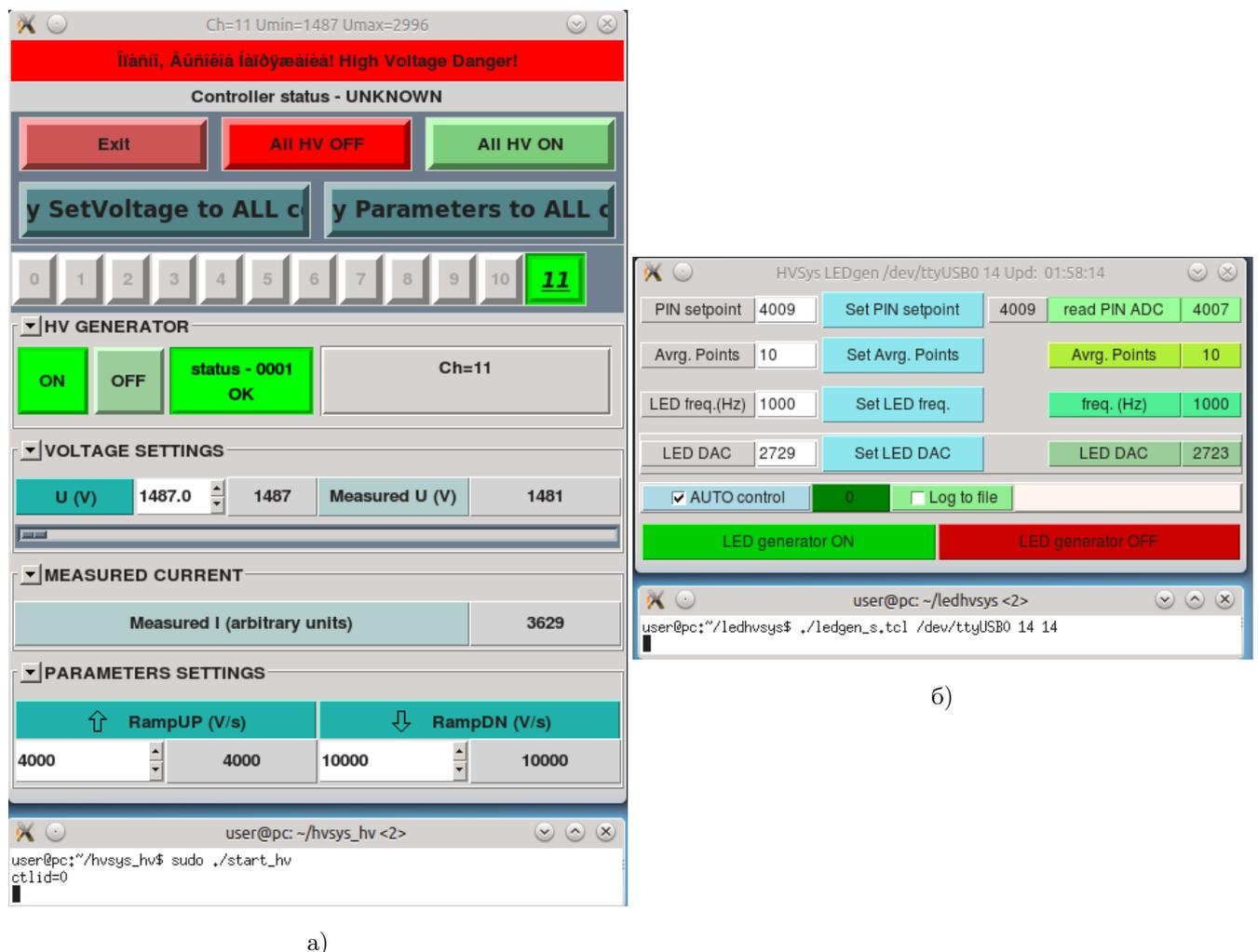
Рис. 4.2: Окна управления высоковольтным питанием(а) и светодиодом(б)
