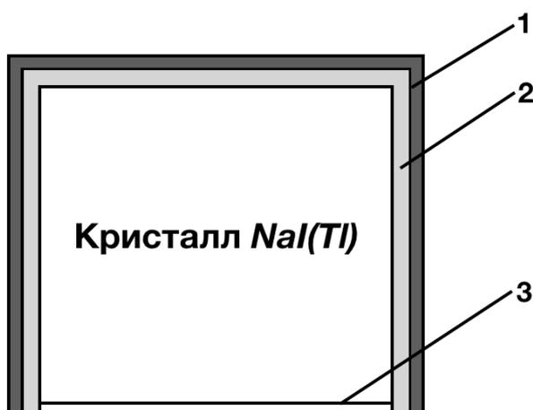
Рис. 3.7: Упаковка кристалла: 1 – дюралевый корпус; 2 – отражатель из оксида магния; 3 – стекло.
