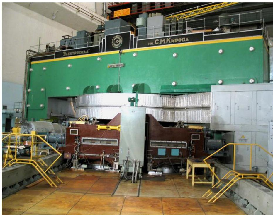
Физический пуск Фазотрона был осуществлен летом 1984 года, т.е. дубненский синхроциклотрон был реконструирован в новый ускоритель — фазотрон со спиральной вариацией нарастающего с увеличением радиуса магнитного поля. Протоны в нем ускорялись до энергии 680 МэВ. При этом максимальный ток внутреннего пучка был увеличен в 4 раза, интенсивность выведенного пучка — в 20 раз. Это существенно расширило спектр исследований в ЛЯП.
