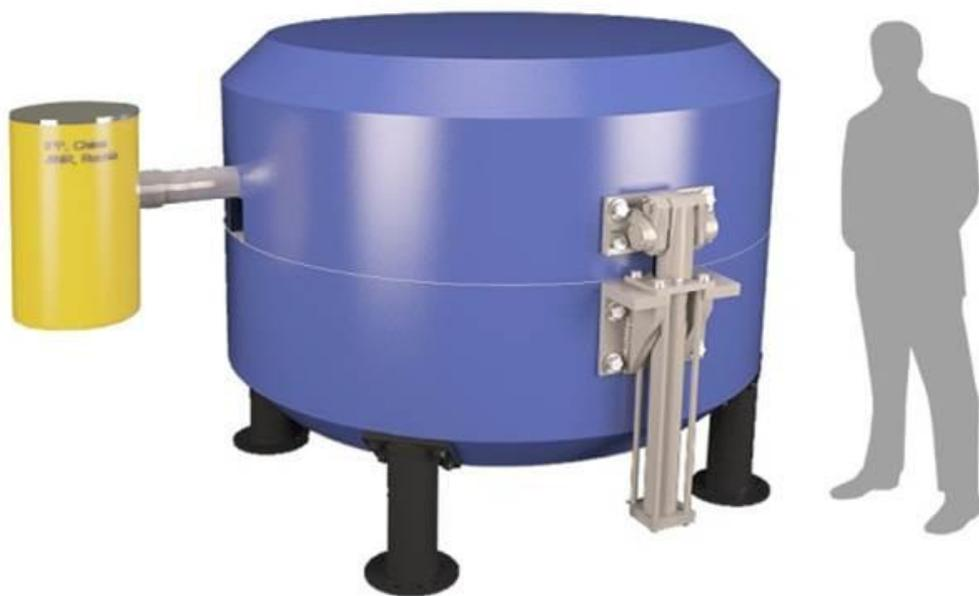
Потребляемая мощность обмоток магнита Фазотрона составляет порядка 750 кВт. Полная же мощность всей установки при работе на медицинский канал составляет 3 МВт!
